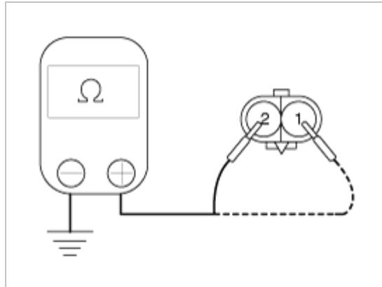
2. 在轮速传感器端子之间连接一个电压表,转发动车轮测量电压。
