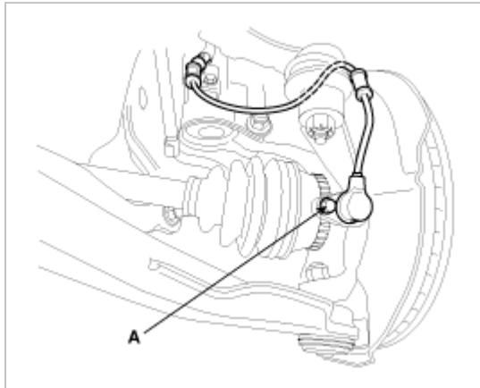
2. 拧下固定在支柱上的固定螺栓。
