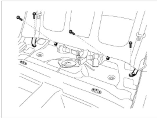
4. 拆卸后座椅侧垫,分离后轮速传感器连接器 (A) 。
